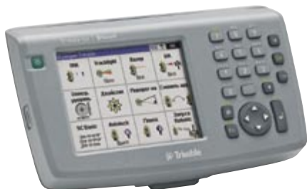
Контроллер Trimble CU специально сконструирован для работы с Trimble S6 и с новейшими GPS системами компании Trimble.
